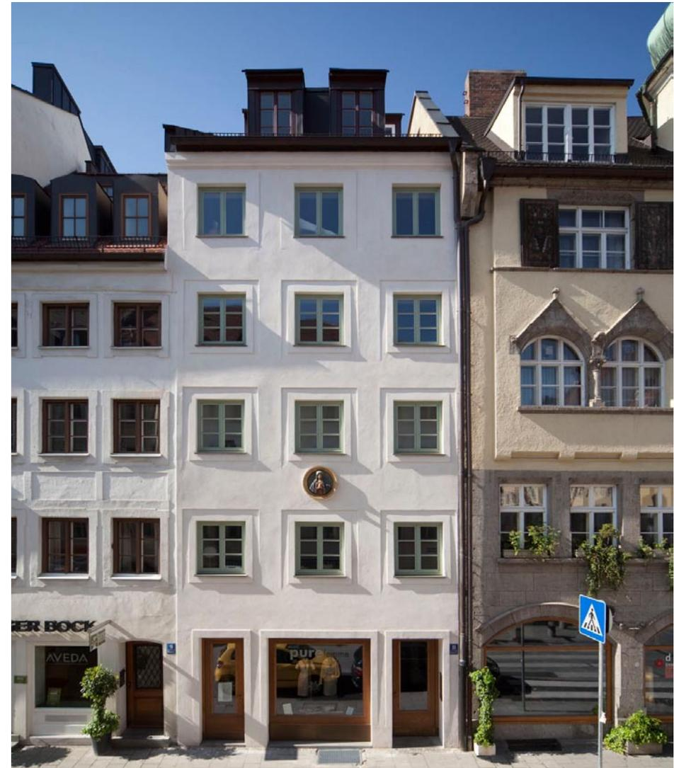
„Die kleine Abweichung“: Umbau und Sanierung eines Hauses in der Münchener Brunnenstraße von Hild und K. Besonders zu beachten sind die um die Fenster laufenden Putzfasschen (gegenläufig gekeippte und eingedrückte Flächen), die die ursprüngliche Formensprache in die Gegenwart transportieren. (Foto: Michael Heinrich)
