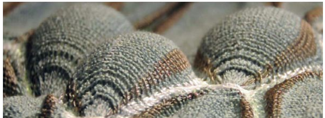
Der Listener ist eine textile, robotische Membran, die ihr Umfeld wahrnimmt und darauf reagiert. (Foto: CITA)
