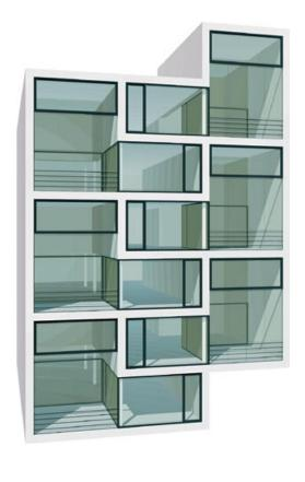
Der Trick: Der durch die Zweigeschossigkeit gewonnene Raum wird nicht als Wohnfläche genutzt, sondern kommt der Wohnung als Luftraum zu Gute. Dadurch wird die Belichtung des tiefen Grundrisses möglich und die Wohnfläche erst tatsächlich flexibel nutzbar. Im Pile Up-Haus bleiben alle Wohnungen eingeschossig: Elegante Maissonetten und gewitzte Split-Level-Lösungen
