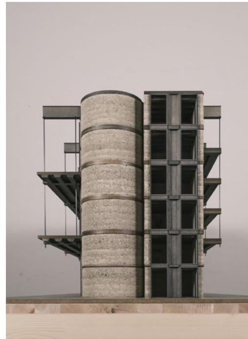
Rechts: Um das Prinzip der freien Kühlung des Ozeaniums in Basel zu prüfen, errichteten Roger Boltshauser Architekten ein Fassaden-Mock-Up im Maßstab 1:1. Foto: Kuster Frey
