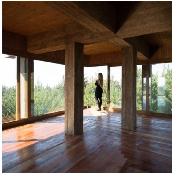
Zwei Ringe aus tragenden Betonstützen verwirren den Grundriss. Der innere Ring läuft vertikal durch, aber die äußeren Stützen werden mit der Glasfassade in jeder Etage weiter nach außen versetzt. „Wir interessieren uns für den Dialog zwischen der Landschaft und dem autonomen Objekt“, sagt Sofia von Ellrichshausen. „Es geht nicht darum, ein skulpturales Haus in die Gegend zu stellen. Es geht um das Verstehen, wie dessen Präsenz etwas Neues entstehen lässt.“
