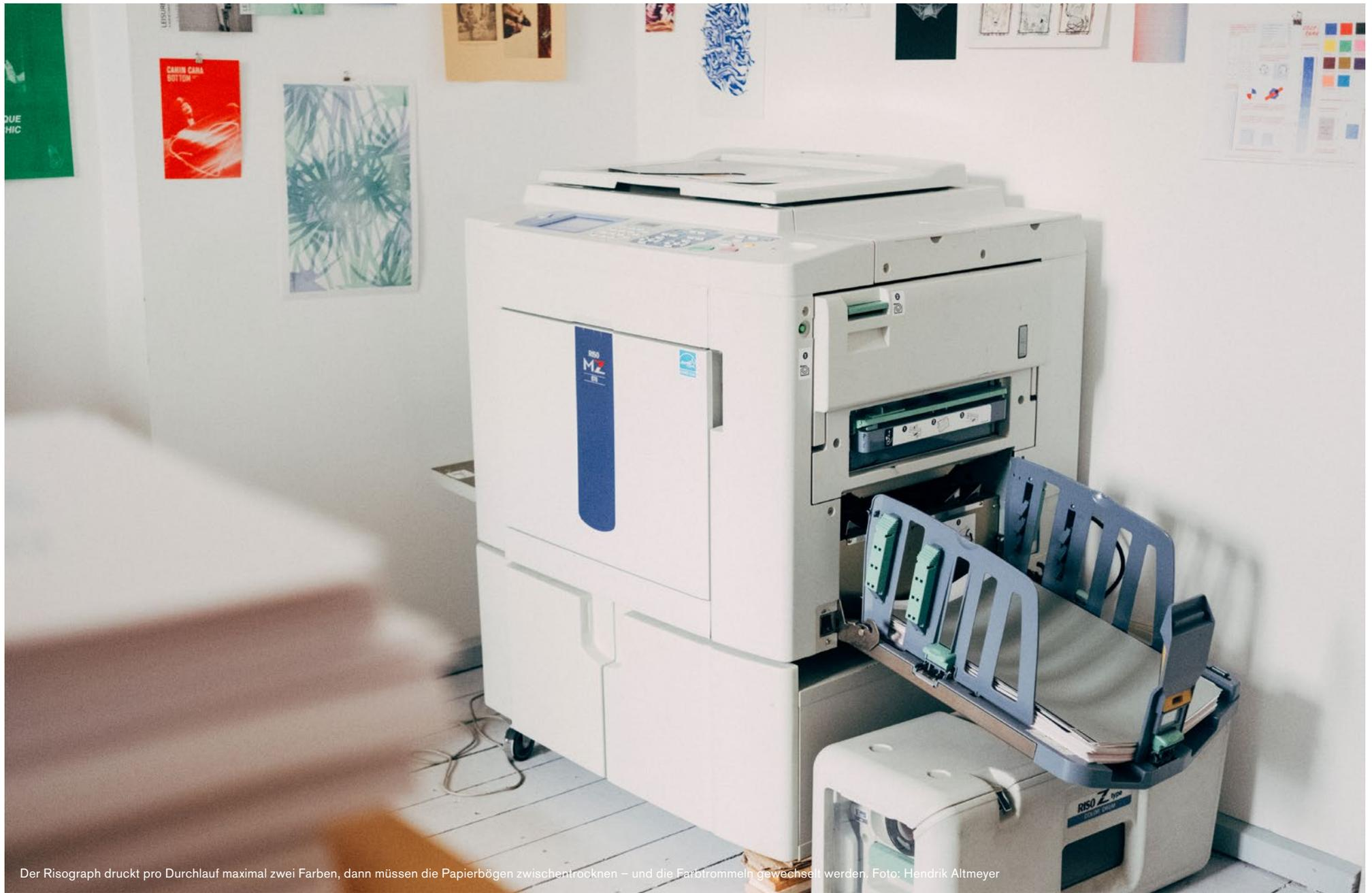
Der Risograph druckt pro Durchlauf maximal zwei Farben, dann müssen die Papierbögen zwischentrocknen – und die Farbtrommeln gewechselt werden. Foto: Hendrik Altmeyer
