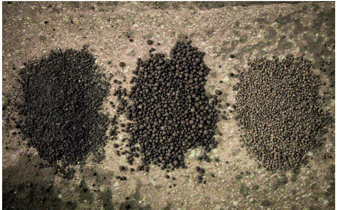
Unterschiedliche Körnungen der Liapor-Tonkügelchen Foto: Barkow Leibinger Architekten
