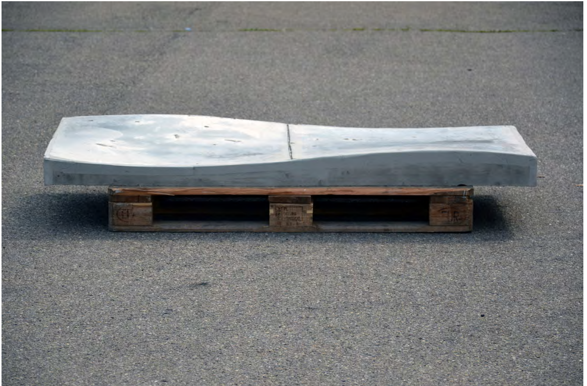
Herstellungsprozess einer wieder verwendbaren Betonschalung auf Wachsbasis, Gramazio & Kohler, ETH Zürich
