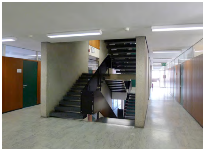
Das Zentrum des Rektorats bildet eine offene Treppenanlage, die schon 1960 aus Brandschutzgründen nicht genehmigungsfähig war. Sie wird jetzt um zwei geschlossene Treppenhäuser ergänzt. Die Flurwände mit Oberlichtern werden abgerissen. Fotos links und rechts: Heinrich Heidersberger, 1960. Foto Mitte: -tze
