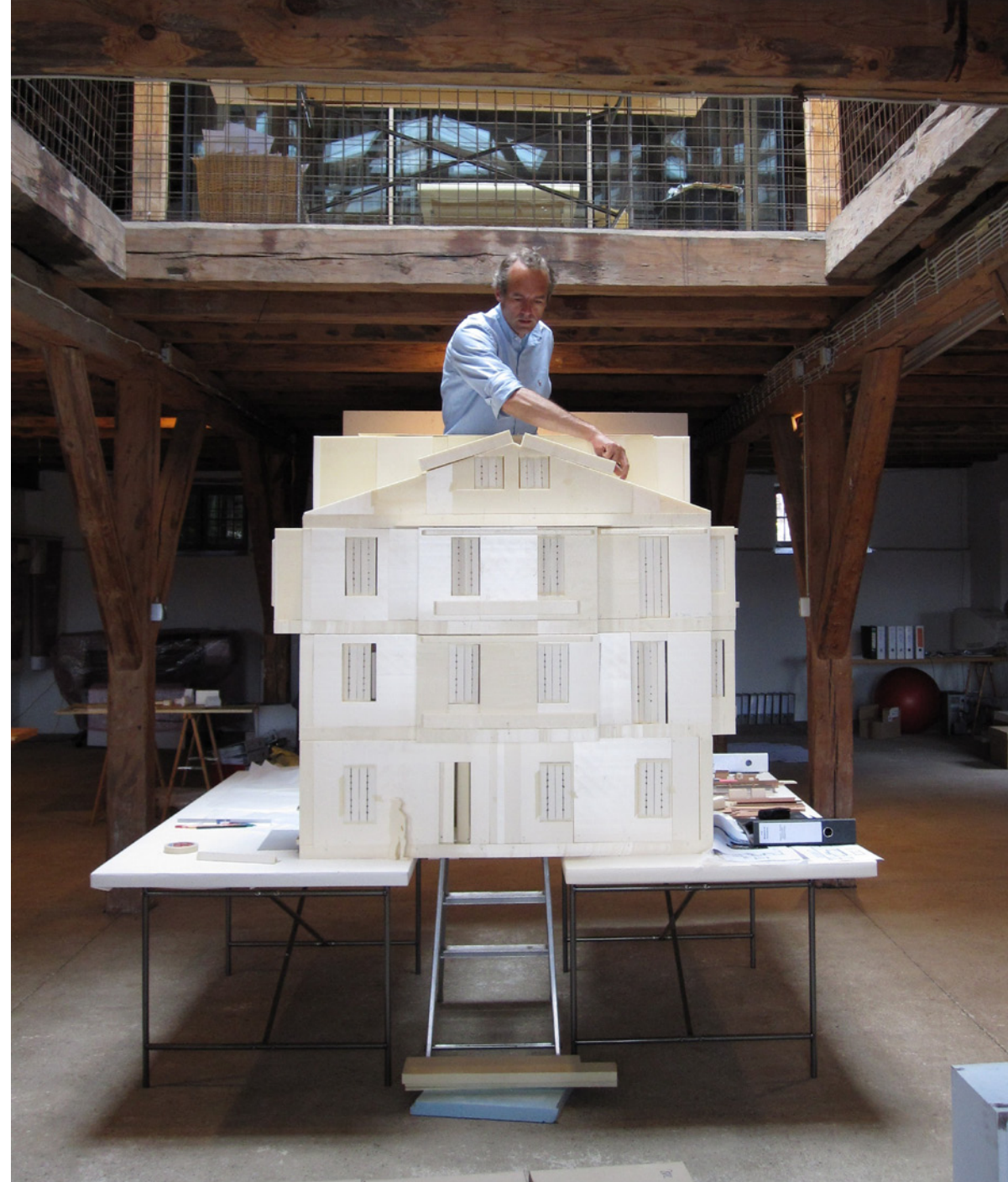
Das Modell wurde zum wichtigsten Entwurfswerkzeug, um alle kleinen Details in dem engen Haus zu prüfen.
