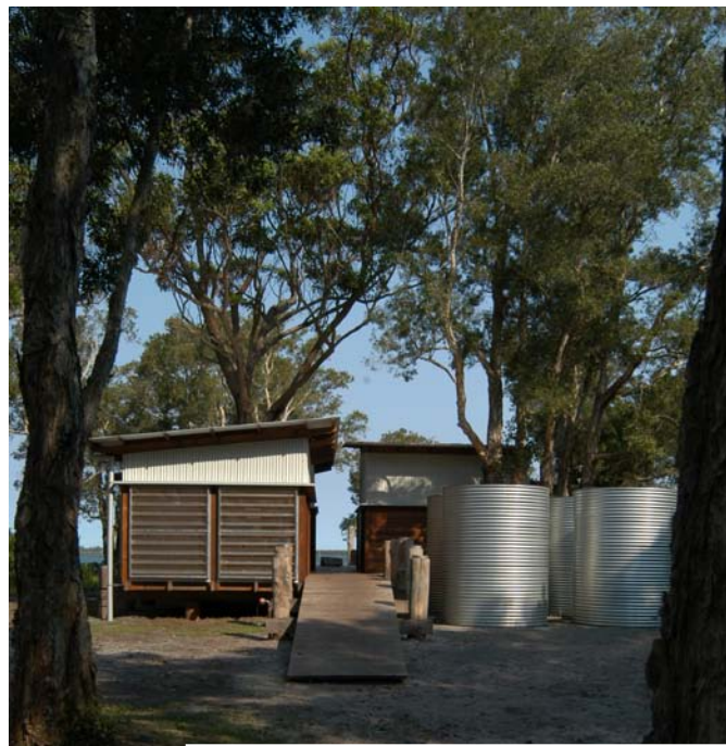
Das Lake House (Casey Brown Architects) reagiert auf den abgeschiedenen Ort mit einem Konzept großer Autarkie. Alle Bauelemente sind vorgefertigt, die Wände sind mit feuerhemmendem, recyceltem Holz verkleidet, das vor Buschbränden schützt. In den Tanks wird Regenwasser gesammelt. Fotos: Rob Brown, East Sydney
