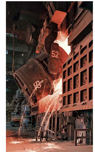
Konverterbefüllung im Oxygenstahlwerk, TKS Hüttenwerk, Duisburg, 2010
