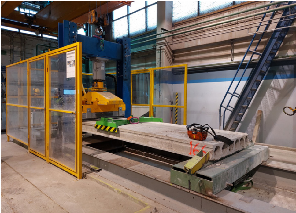
Links: Ein Hohldeckenelement zur Aufbereitung in der Fertigteilfabrik in Kangasala. Foto: Satu Huuhka
