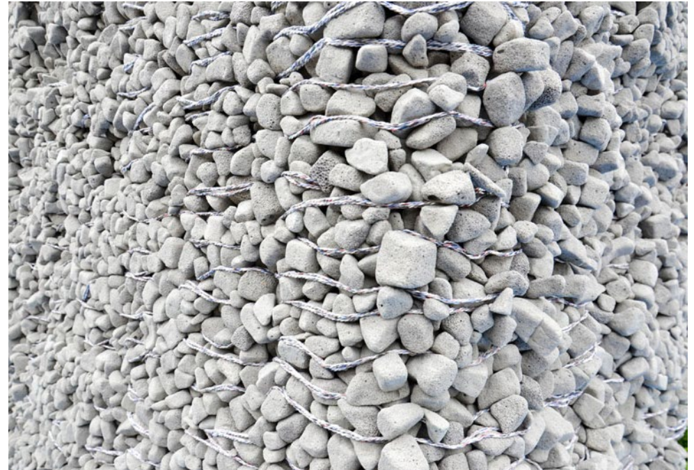
Das Forschungsprojekt „Jammed Architectural Structures“ (2015-2018) untersucht die roboterbasierte Verbindung von losen Grundmaterialien. Foto: Gramazio Kohler Research, ETH Zürich
