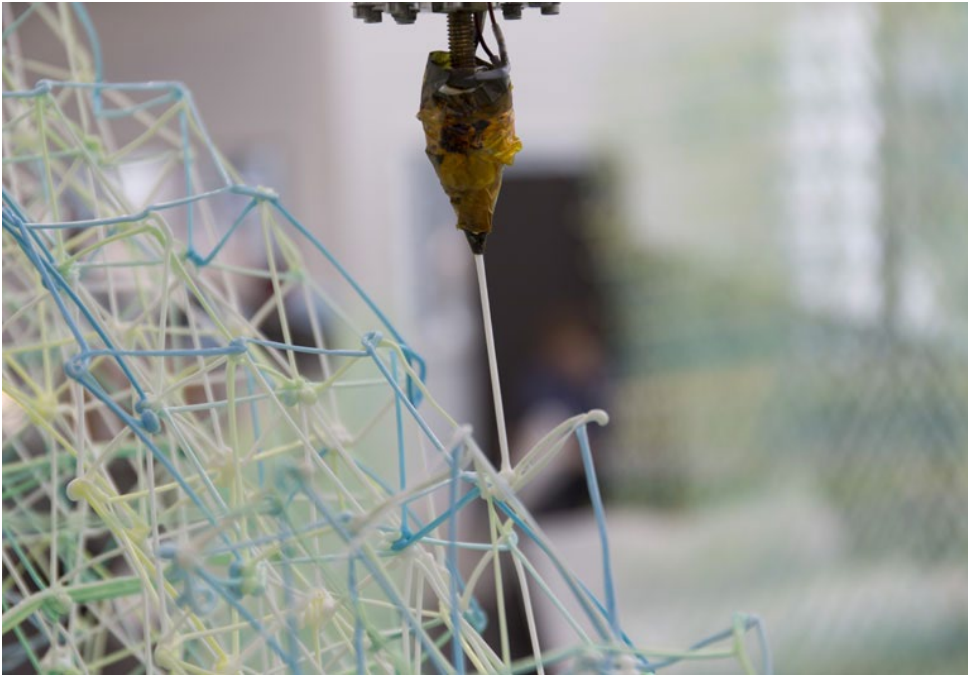
„Iridescence Print“, Installation im Palais de Tokyo in Paris (2015). Die erste großmaßstäbliche Architekturinstallation, die von einem roboterbasierten 3D-Druckverfahren realisiert wurde. Foto: Gramazio Kohler Research, ETH Zürich
